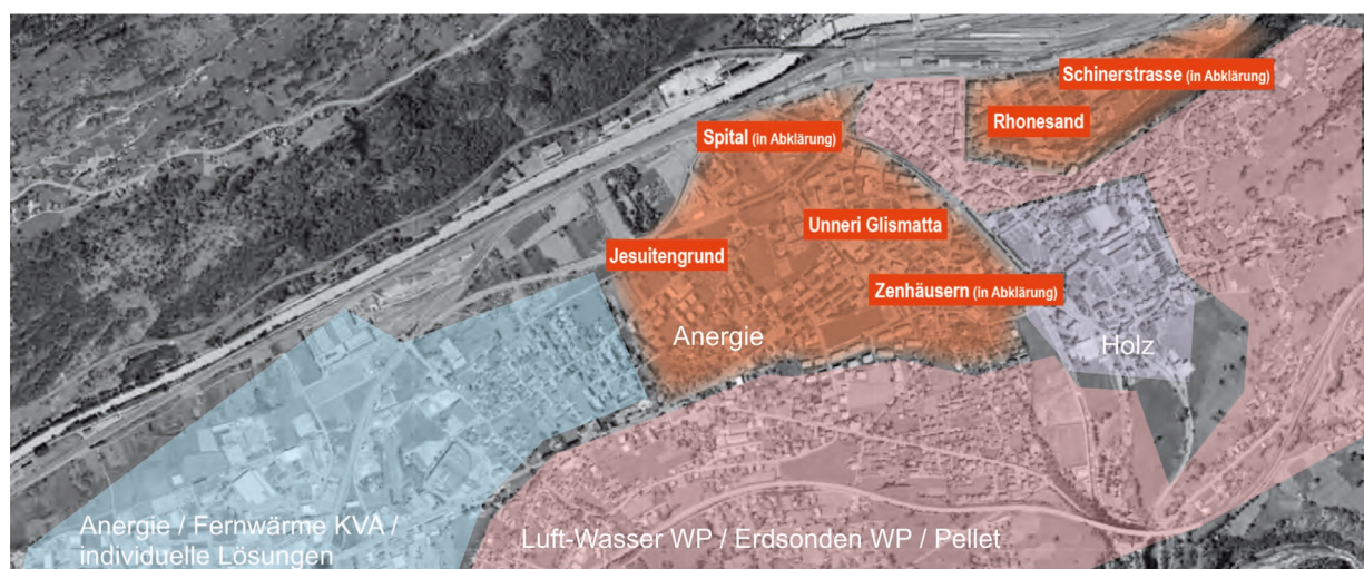
Abbildung 34: Zuordnung alternativer Heizsysteme nach Gebieten basierend auf den Energiepotentialen.
